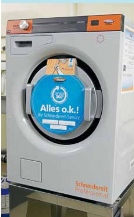
Das an der Maschine angebrachte Serviceprotokoll sagt dem Anwender, ob und ab wann die Maschine wieder genutzt werden kann.
