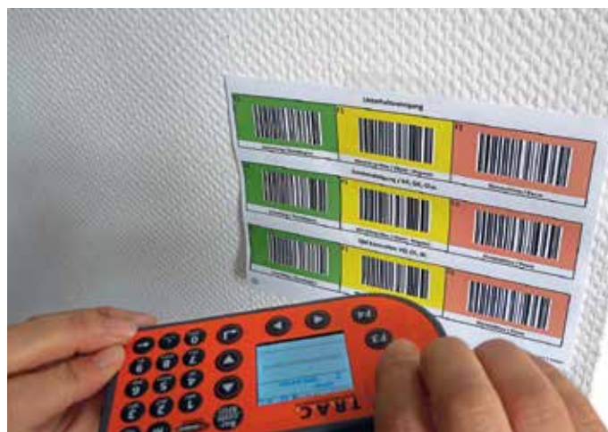
Der mobile Datenscanner T.R.A.C. dient der Betriebsdatenerfassung und Qualitätskontrolle.
